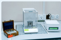
Rys. 1. Stanowisko pomiarowe do wzorcowania i legalizacji wzorców masy, odważników i obciążników
