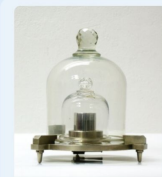
Rys. 8. Państwowy wzorzec jednostki miary masy - prototyp kilograma nr 51
