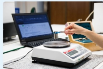
Rys. 2. Stanowisko pomiarowe do wzorcowania wag nieautomatycznych
