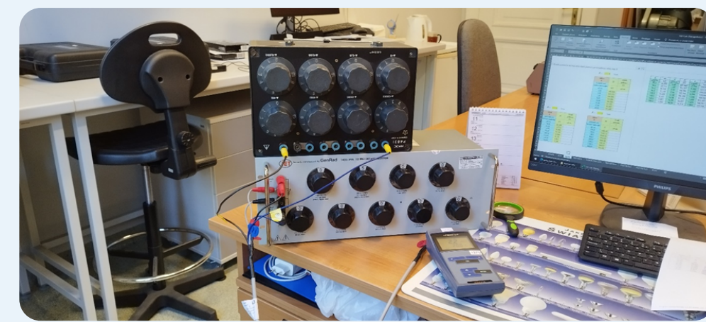
Rys. 4. Stanowisko pomiarowe do wzorcowania konduktometrów metodą elektryczną
