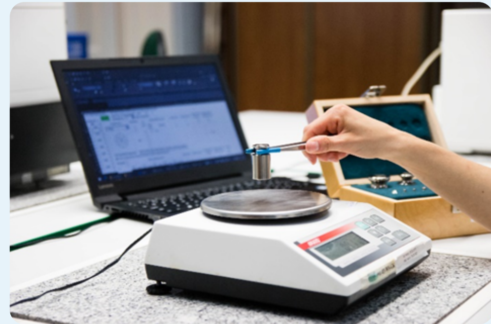
Rys. 2. Stanowisko pomiarowe do wzorcowania wag nieautomatycznych
