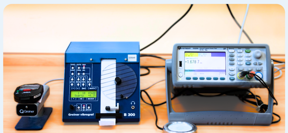
Rys. 5. Stanowisko pomiarowe do wzorcowania sekundomierzy mechanicznych oraz sekundomierzy elektronicznych sterowanych ręcznie i elektronicznie (wyznaczenie błędu pomiaru krótkoterminowego częstotściomierzem - czasomierzem i błędu pomiaru długoterminowego chronokomparatorem)
