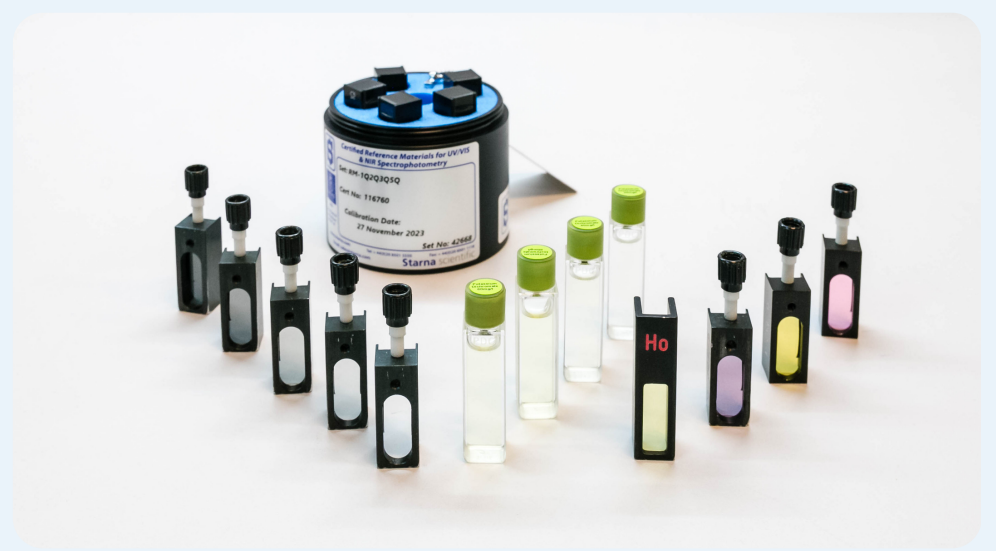
Rys. 3. Wzorce pomiarowe - zestaw filtrów ciekłych stosowanych w zakresie ultrafioletu oraz zestaw filtrów szklanych stosowanych w zakresie widzialnym i bliskiej podczerwieni.
