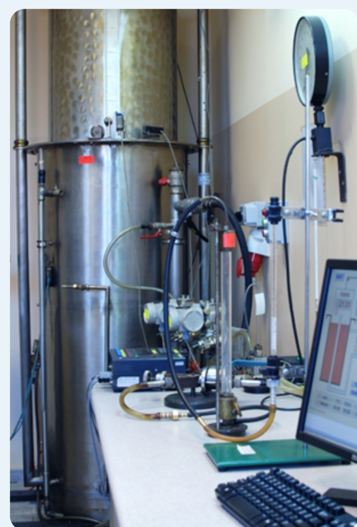
Rys. 6. Niskociśnieniowe stanowisko pomiarowe do wzorcowania rotametrów do gazów w zakresie strumienia objętości od 1 dm 3 /h do 15000 dm 3 /h
